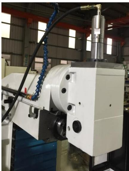
3. LSG-400D Защитная крышка для защиты горизонтального / вертикального шпинделя.
